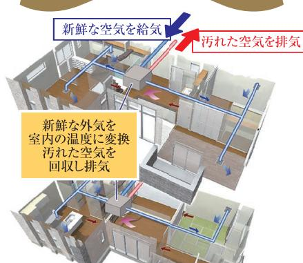
独自の全館空調システム「ブローボックス」により最小限のダクトで家中の空気を均一化。コストを抑えつつ快適な温熱環境を実現します。
